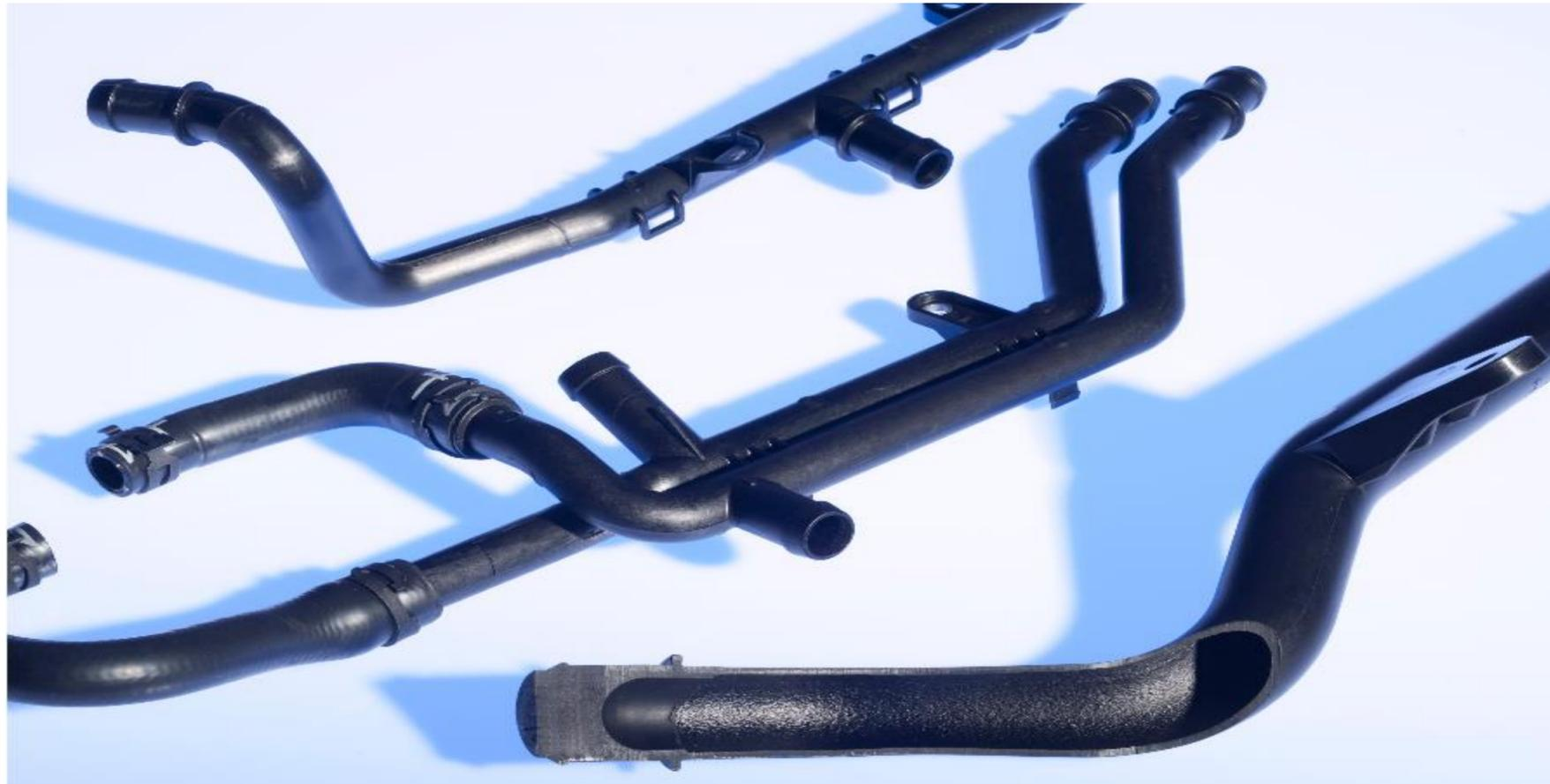
**E' preferibile stampare tubi ricurvi mediante stampaggio assistito da acqua che non mediante stampaggio assistito da gas perché l'acqua resta al centro del tubo nelle curve, mentre il gas genera spessori più sottili all'esterno della curvatura.**
